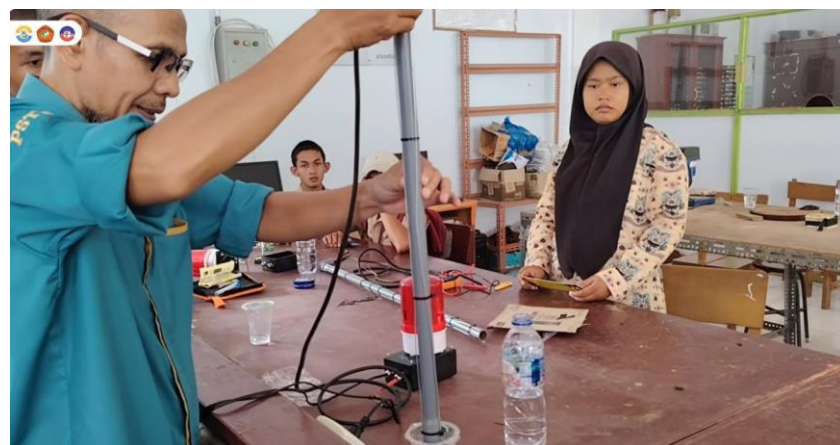
Gambar 6. Peserta melakukan simulasi pengujian kenaikan level air pada bejana akrilik uji untuk memverifikasi keandalan aktivasi lampu rotator 12 V dan sirine warning saat level air kritis tercapai.
