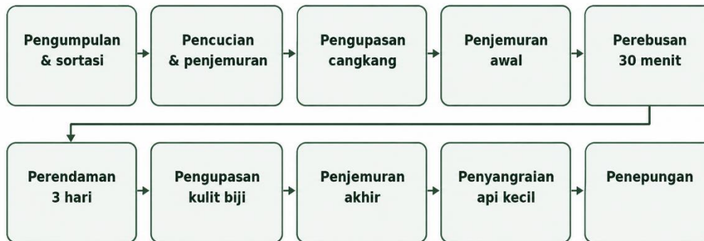
Gambar 4. Alur utama pengolahan biji trembesi menjadi tepung
