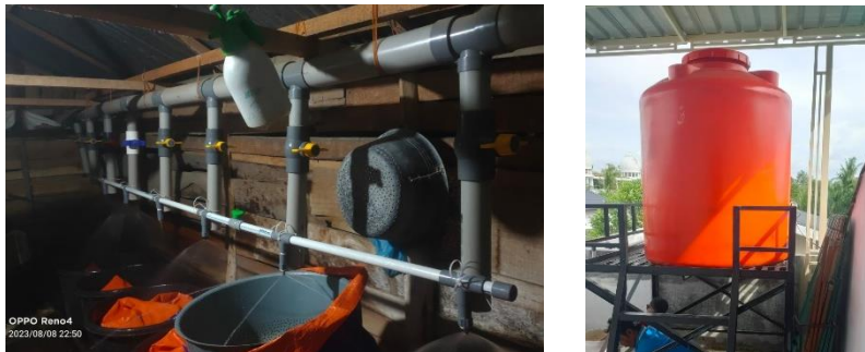
Gambar 2. Sistem penyiraman otomatis berbasis timer dan tandon penampung air (reservoir)
